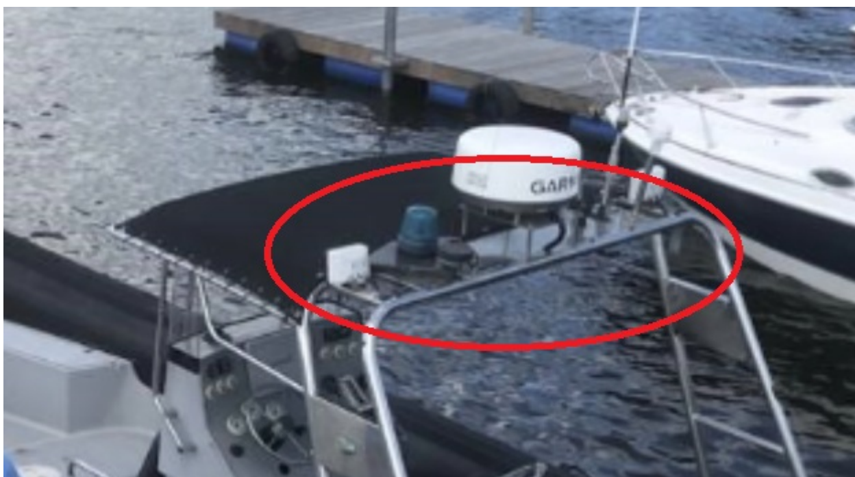
Foto 5: T-top (targa) com a sua base de inox e descolada do toldo para facilitar a passagem de fios elétricos
