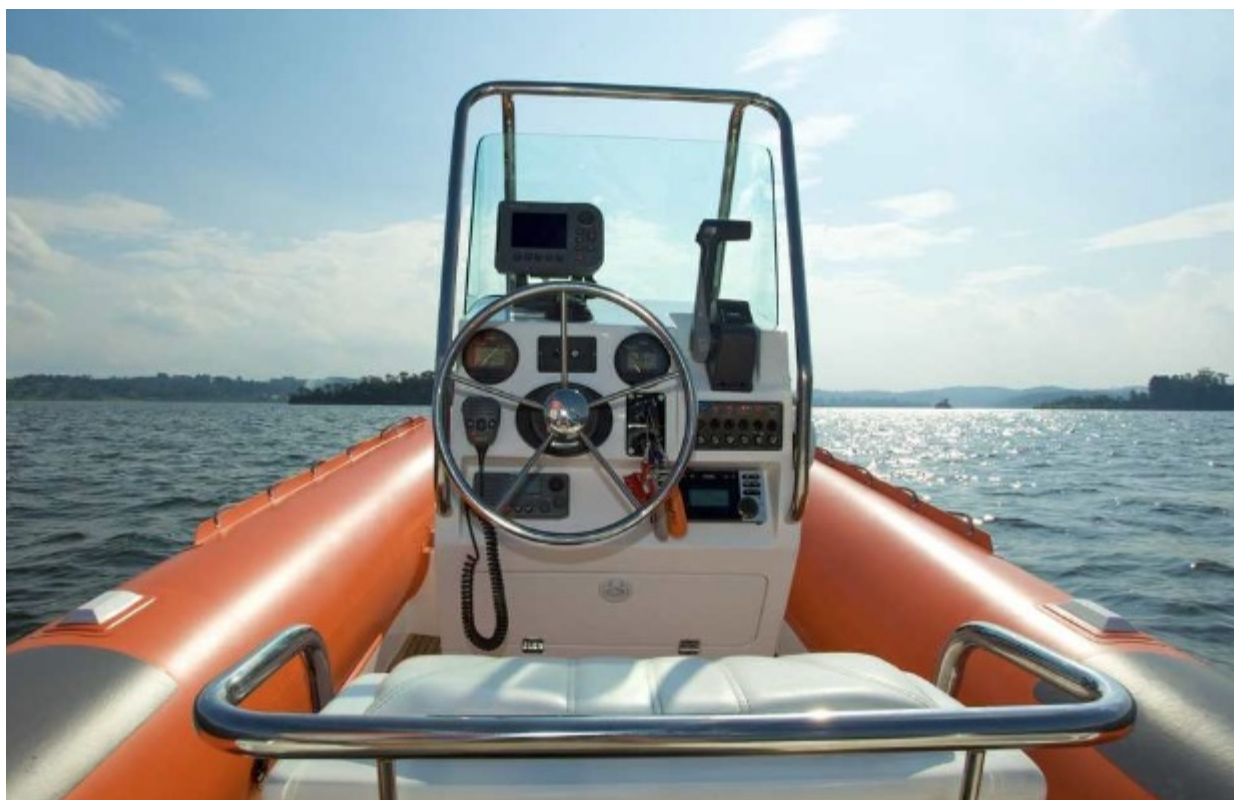
Foto 6: painel de comando (cockpit) centralizada e com timão em inox
